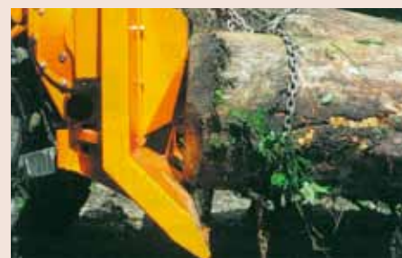
Strmejša sidrna deska zagotavlja večjo stabilnost pri privlačenju bremena.
