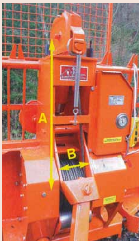
Položnejši zaključek sidrne deske za lažje rampanje hlovov.
