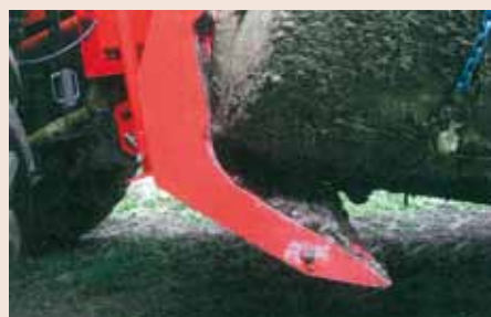
Položnejši zaključek sidrne deske za lažje rampanje hlovov.
