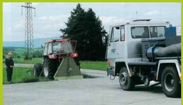
Za trajno obremenitev so uporabili testno vozilo BLT, s katerim merijo vlečno moč traktorjev. Vitel so za dobo 5 ur obremenili na 80 % nazivne vlečne sile.
