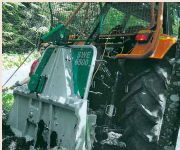
Spodnji škripec je fiksno pričvrščen, tako da njegove višine ni možno spreminjati.
